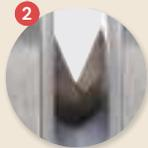
2 Meule en carbure de tungstène : Aiguisé
